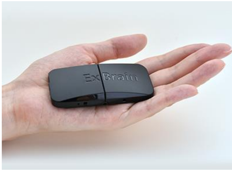
Figure 1. 超小型脳活動センサー "XB-01". Copyright by 株式会社 NeU
